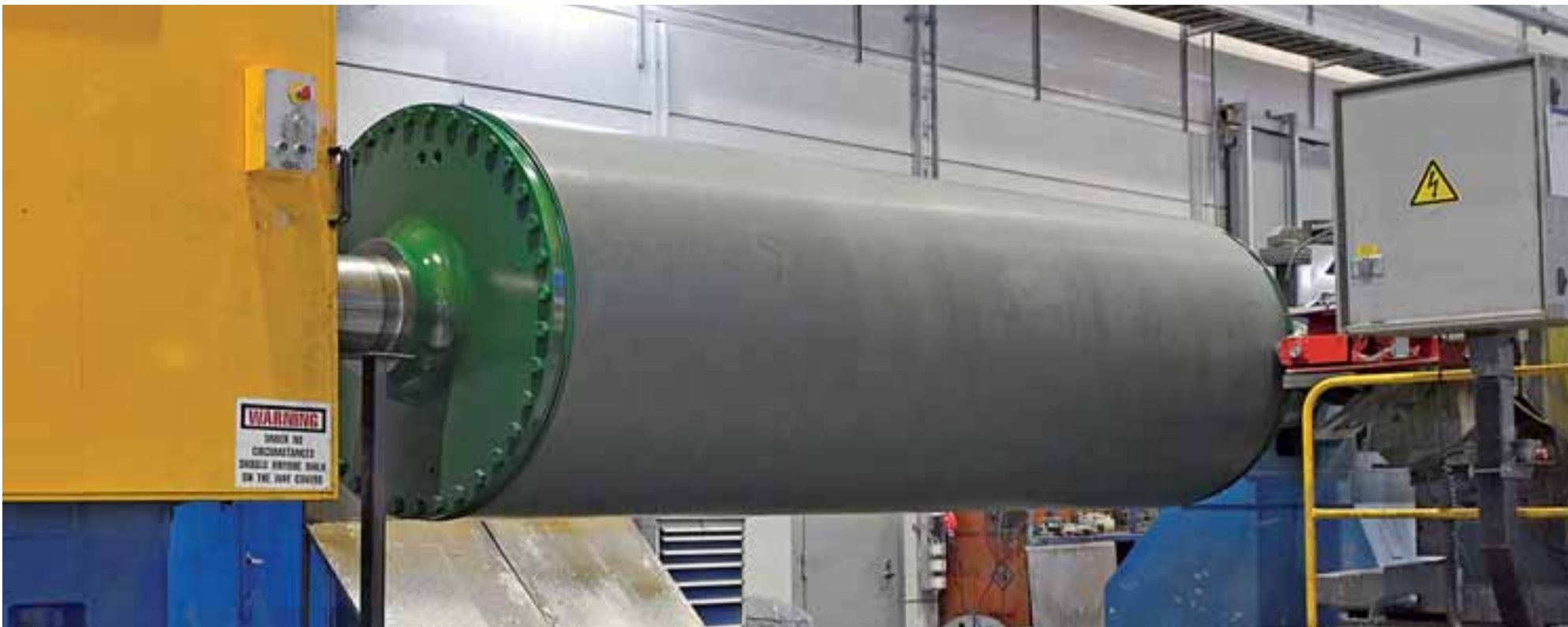
Одной из новейших научно-исследовательских и опытно-конструкторских разработок стало покрытие АК-Керам. Оно идеально подходит для валов прессовой части.
