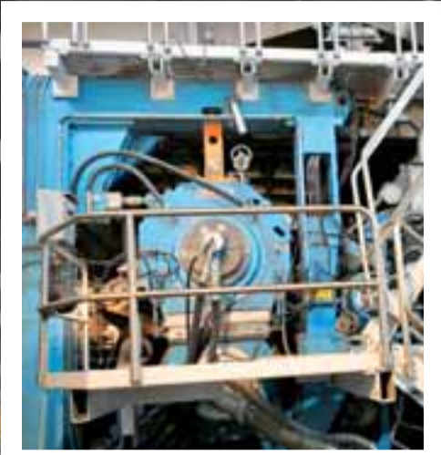
Башмачный пресс Ваахто обеспечивает минимум 50% сухости.
